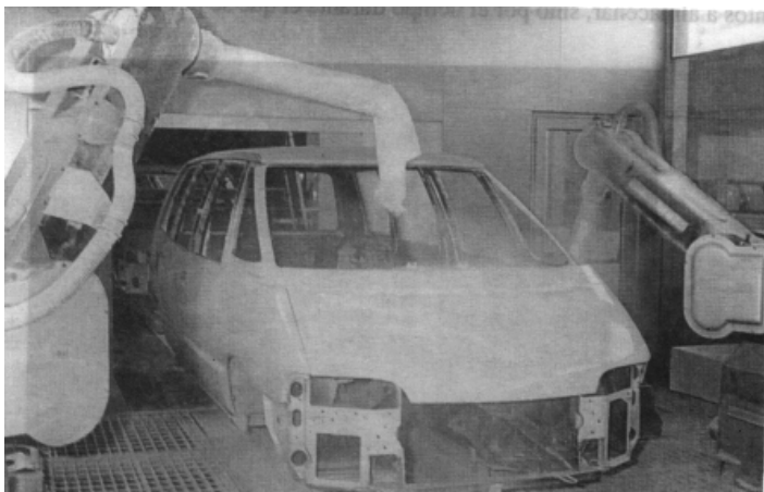
Robotak (FANUC) auto-karrozeriaren pintatze-lanetan.
